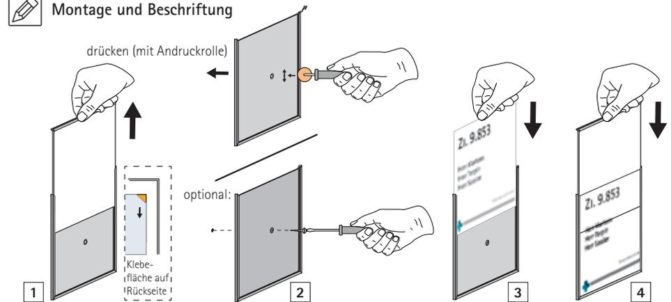
**1** Abdeckung nach oben (Hochformat) herausnehmen. Schutzfolie vom umseitig aufgetragenen Klebeepad abziehen.
