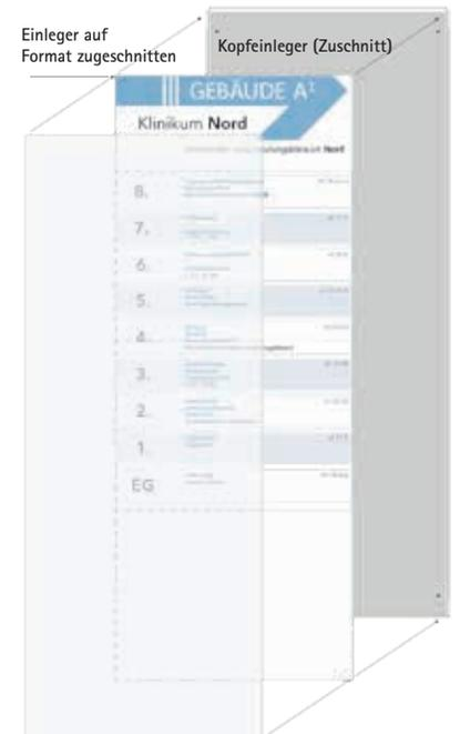
Mehrteilige, papierflexible Stockwerkübersicht mittels EasyFlexx.
